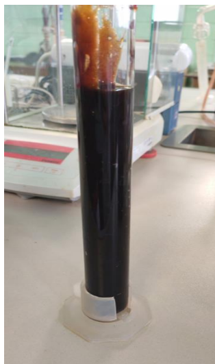
Рисунок 2 — Определение плотности мелассы с помощью ареометра
