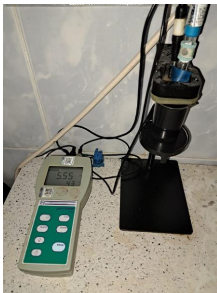
Рисунок 3 —Определение pH мелассы с помощью pH-метр
