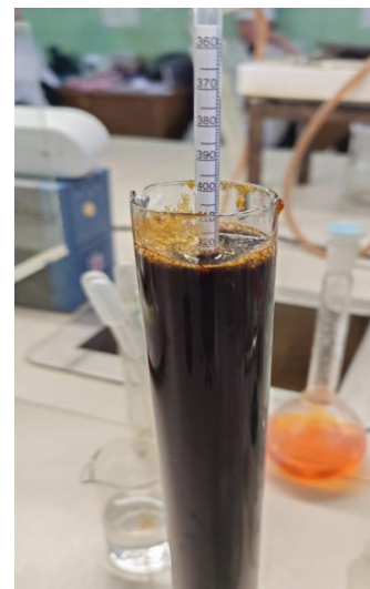
Рисунок 2 — Определение плотности мелассы с помощью ареометра
